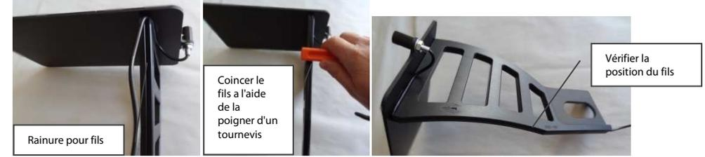
**INSTALLER LE SUPPORT DE PLAQUE D'IMMATRICULATION:** installation sur l'axe de roue arrière gauche.
